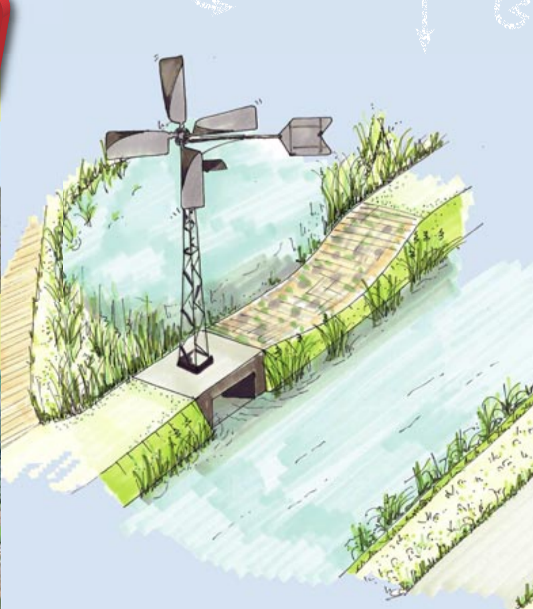
Windmolens zorgen voor het waterpeil in het proeftraject Blik-Klassen
